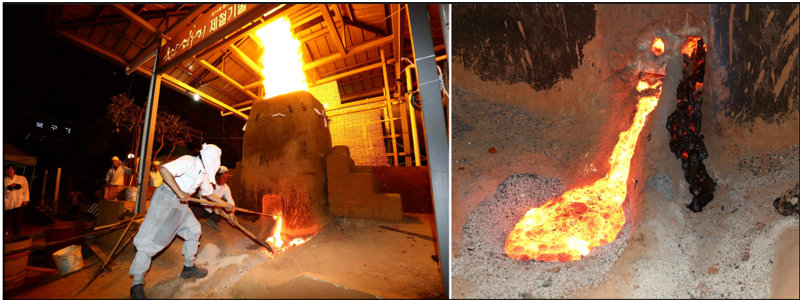
그림 4. 울산쇠부리축제 제4차 제철복원실험 (2018년 5월 12일; 좌-가마의 구조 및 실험 광경, 우-쇳물과 철재의 유출 광경)
