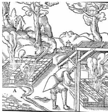
<그림 6> 배소장(焙燒場) 씻기(洗滌) (E: 물흐르는水路, 아그리콜라, 1950:274)
