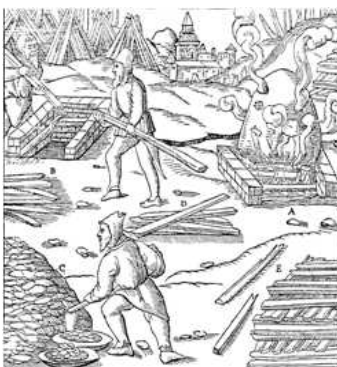
<그림 5> 배소장(焙燒場)에 철광석 넣기 (A: 소결가마, C: 철광석, 아그리콜라, 1950:275)
