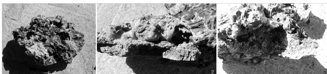
〈그림 52〉 노 밖으로 분리된 벽체(1 평면, 1 단면(미장면과 보강점토 구분 명확), 3 단면(미장면과 보강점토 모두 용융))
