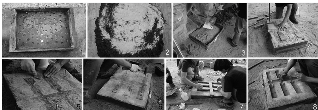
〈그림 20〉 판장쇠바탕 제작 과정(1:판장쇠바탕틀, 2:주물사, 3~8:판장쇠바탕 제작과정)
