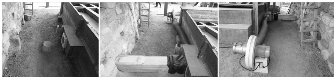
〈그림 15〉 풀무와 가마 연결(좌:풀무 송풍구, 중:바람구멍 연결, 우:기계 송풍기 연결)
