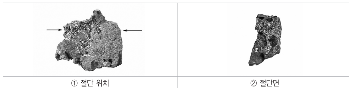
〈사진 15〉 가마 바닥 형성물-철재(21U-15B)의 절단면 위치와 절단면
