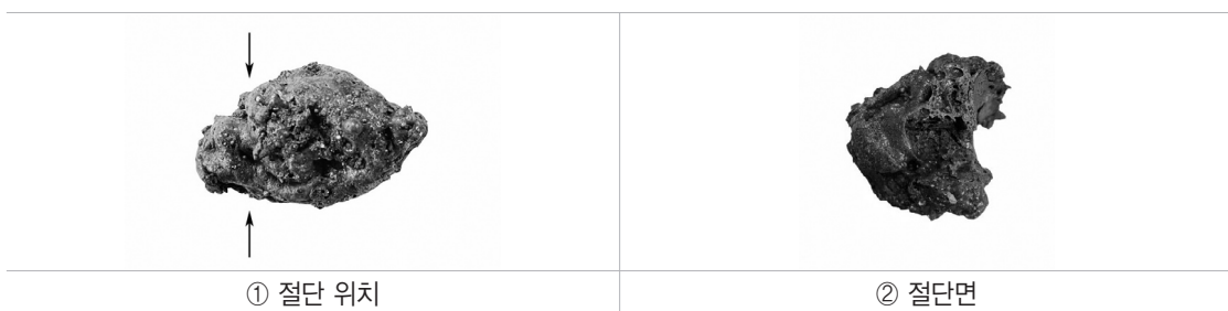
〈사진 4〉 유출 전 확인 슬래그(21U-5)의 절단면 위치와 절단면
