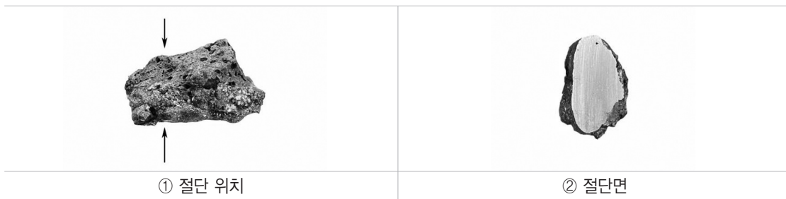
〈사진 13〉 가마 바닥 중간 형성물-선철(21U-14M)의 절단면 위치와 절단면
