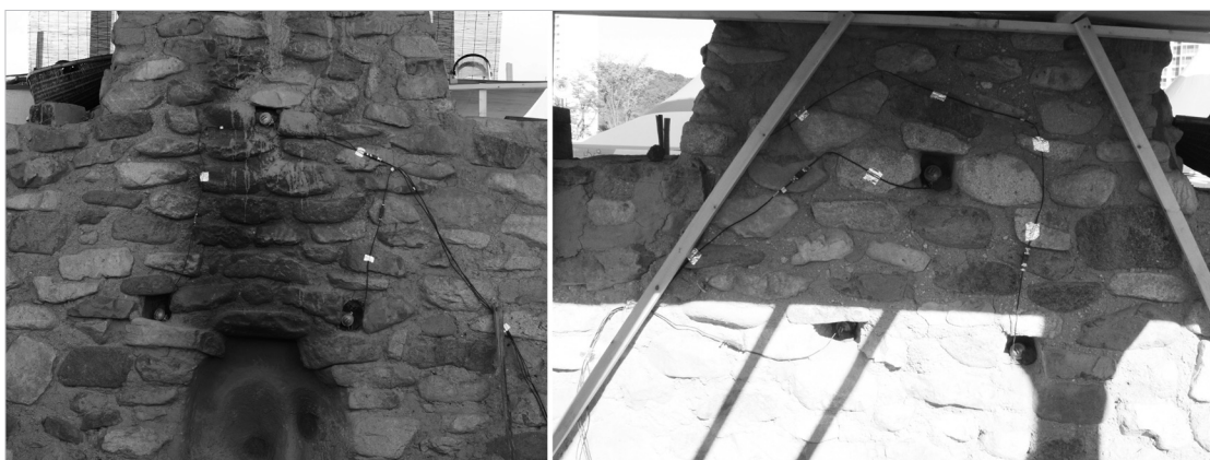
<그림 32> 온도센서 설치 모습
