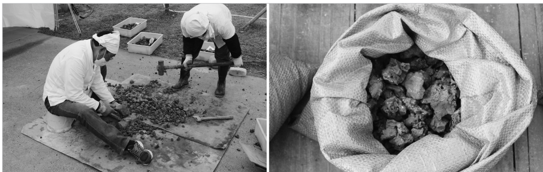
〈그림 7〉 첨가제(슬래그) 파쇄 및 포장
