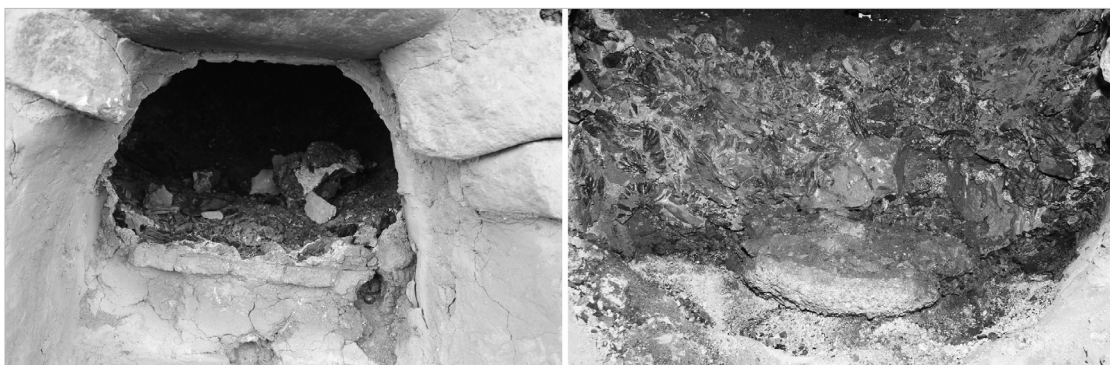
〈그림 40〉 실험 종료 후 앞창 일부 제거 및 가마 내 형성물 절단 모습
