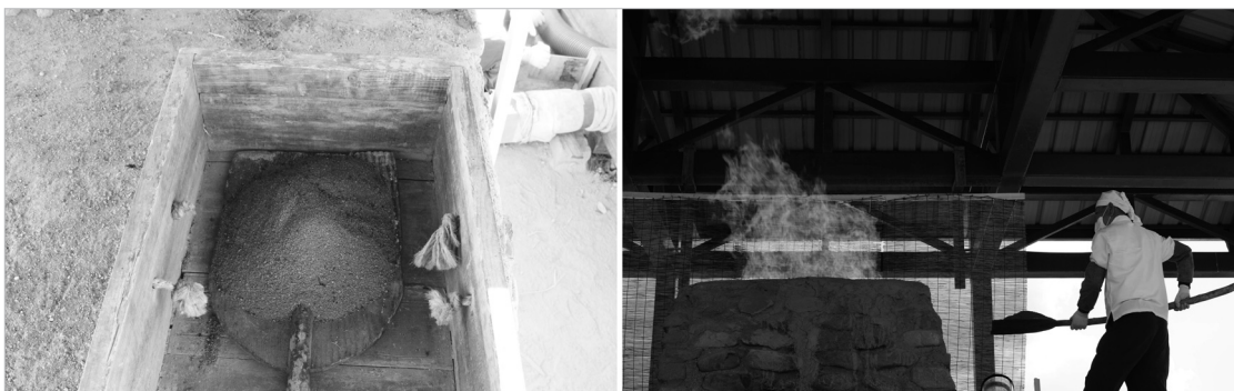
〈그림 27〉 원료(분광) 장입 준비 및 장입 모습
