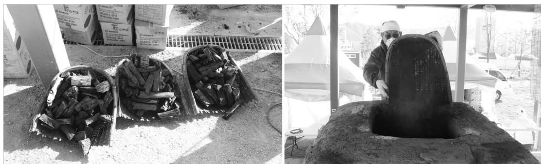
〈그림 29〉 연료(목탄) 장입 준비 및 장입 모습(1)
