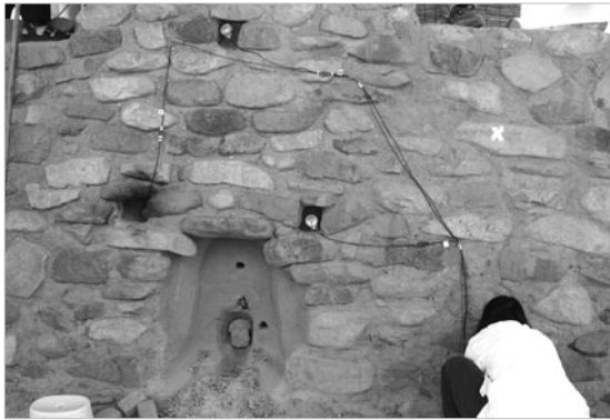
〈사진 85〉 온도센서 설치 사진(가마 앞쪽)
