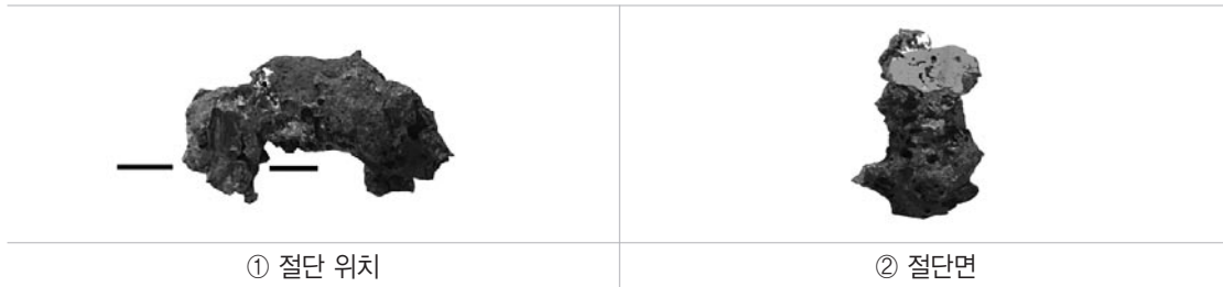
〈사진 139〉 송풍구앞 선철대의 괴련철(20U-31)의 절단면 위치와 절단면
