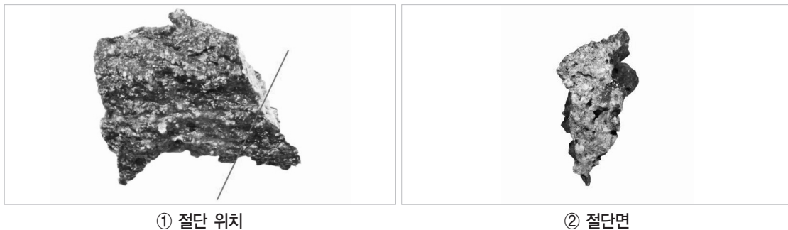
〈사진 33〉 7위치 노벽 부착 철재(19U-25)의 절단면 위치와 절단면
